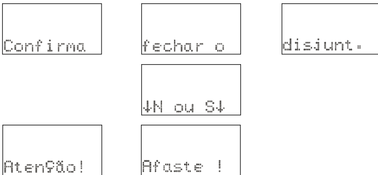
Figura 3.10: Comando local para fechar o disjuntor.
