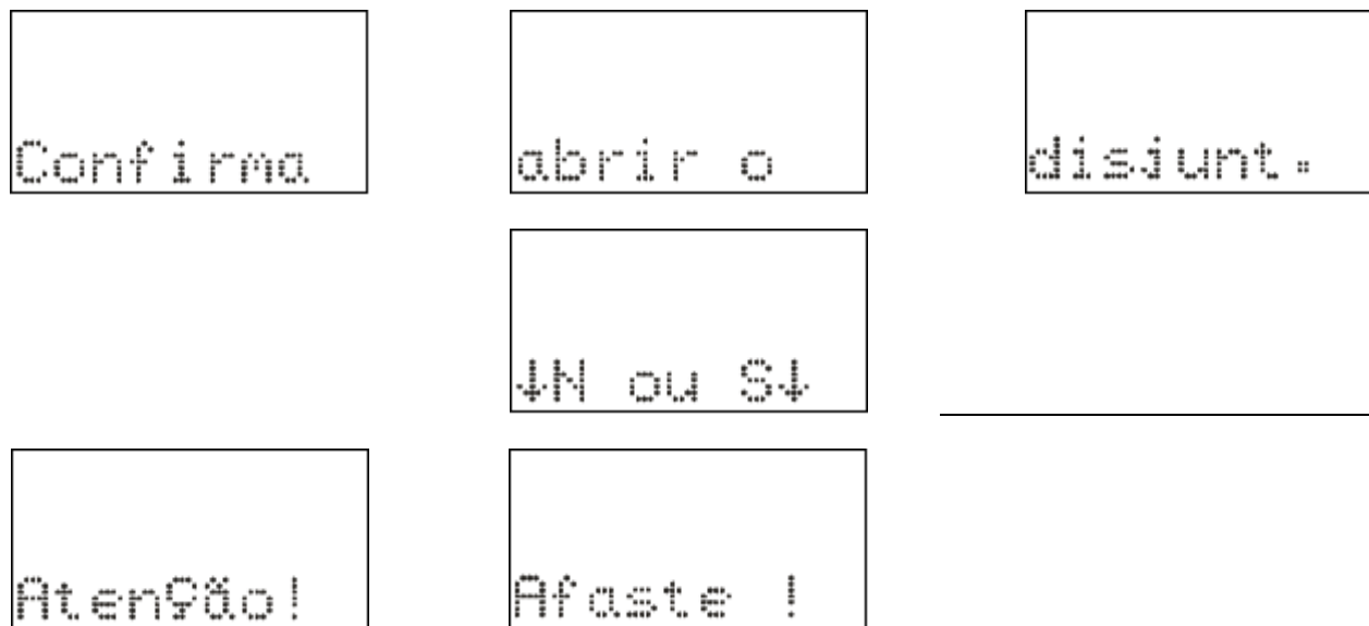
Figura 3.12: Comando local para abrir o disjuntor.
